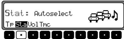
Mit dem rechten Drehregler
