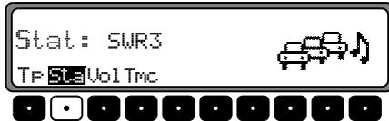
Mit dem rechten Drehregler
