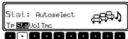
Mit dem rechten Drehregler
