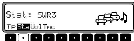
Mit dem rechten Drehregler
