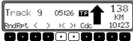
Durch mehrfaches Betätigen der Multifunktionsstasten können mehrere Titel vorwärts oder rückwärts übersprungen werden. Wird der letzte Titel erreicht, erfolgt ein Wechsel auf den ersten Titel. Analog erfolgt ebenfalls ein Wechsel vom ersten auf den letzten Titel.
