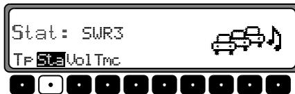
Mit dem rechten Drehregler **Autoselect** gewünschten TP Sender auswählen. Nach kurzer Zeit ohne Bedienung wird der eingestellte Sender übernommen.
