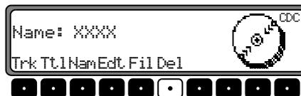
Nun kann durch Drücken der Multifunktionsstaste **Del** der Namen gelöscht werden.
