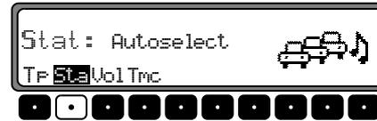
Mit dem rechten Drehregler **Autoselect** auswählen und durch Drücken bestätigen. Nach kurzer Zeit ohne Bedienung ist die direkt Programmierung gelöscht.
