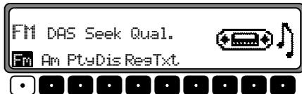
Im FM DAS Betrieb werden die empfangbaren Sender je nach Einstellung über den Multifunktionstasten angezeigt.
