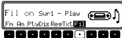
Mit dem rechten Drehregler ● können die einzelnen Programme ausgewählt werden. Durch Drücken des rechten Drehreglers ● kann nun zwischen Play (Programm ungefiltert) und Skif (Programm ausgefiltert) ausgewählt werden.
