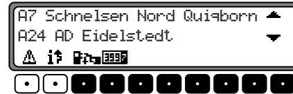
Durch Drücken der Multifunktionsstaste **A** wird eine Liste aller im Moment verfügbaren aktuellen Verkehrsinformationen angezeigt.
