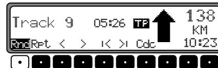
Nach nochmaligem Drücken der Multifunktionsstaste **Rnd** wird die Funktion „Zufallsgenerator“ gelöscht.
