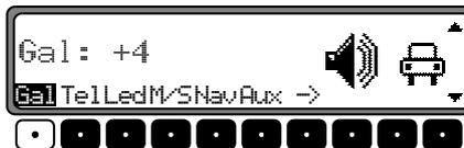
Mit der GAL - Einstellung kann der Start der Lautstärkeanhebung entsprechend der Fahrtgeschwindigkeit festgelegt werden.
