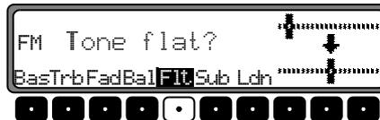
Multifunktionstaste **Fit** kurz drücken - es erscheint **Tone flat**. Durch erneutes Drücken der Multifunktionstaste **Fit** werden die Klangeinstellungen der momentan eingestellten Signalquelle (z.B. FM) auf einen Mittelwert eingestellt.
