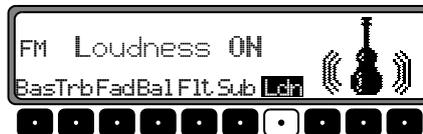
Mit der Multifunktionstaste **Ldn** zwischen Loudness ein (ON) bzw. Loudness aus (OFF) wählen. In den Wellenbereichen MW, LW, SW ist Loudness abgeschaltet.
