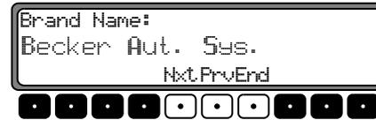
Mit den Multifunktionstasten **Nxt** und **Prv** bzw. durch Drehen des rechten Drehreglers
