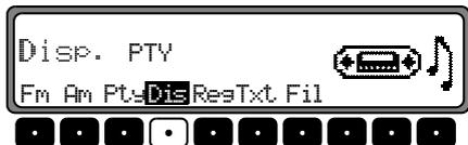
Mit der Multifunktions-taste **Dis** zwischen PTY (PTY Anzeige eingeschaltet) oder Frequency (PTY Anzeige ausgeschaltet) wählen.
