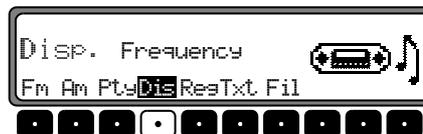
Mit der Multifunktions-taste **Dis** zwischen Frequency (Frequenzanzeige eingeschaltet) oder PTV (Frequenzanzeige ausgeschaltet) wählen.
