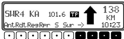
Der gewünschte Sender wird eingestellt, indem die Taste unterhalb der Abkürzung der Sendeanstalt gedrückt wird. Strahlt der gewählte Sender mehrere Programme/Regionalprogramme aus, kann in einem automatisch eingeblendeten Untermenü das gewünschte Programm gewählt werden.
