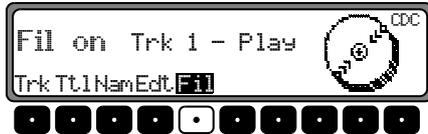
Beim CD - Wechsler Silverstone 2660 können mit dem rechten Drehregler ● die einzelnen Titel der laufenden CD ausgewählt werden. Durch Drücken des rechten Drehreglers ● kann nun zwischen **Play** (Titel ungefiltert) und **Skip** (Titel ausgefiltert) ausgewählt werden.
