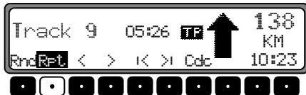
Nach nochmaligem Drücken der Multifunktionstaste **Rpt.** wird die „Titelwiederholung“ ausgeschaltet.
